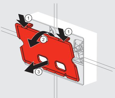
**2. Klappen Sie die Betätigungsplatte aus dem WC-Modul aus.** Lösen Sie zunächst die Verriegelungen, mit denen der Plattenrahmen gesichert ist. Verwenden Sie dann die seitlichen Klammer, um die Platte selbst zu lösen und zu entfernen.
