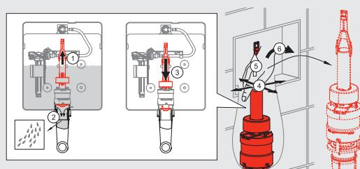
**9. Entfernen Sie Schmutz vom Boden des Tanks.** Spülen Sie den Tank mit dem vom Füllventil getrennten Schlauch
