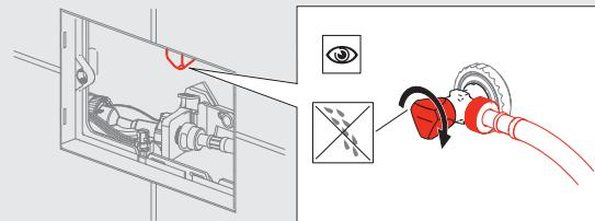
**7. Trennen und entfernen Sie das Füllventil.**
