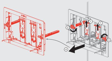
**4. Wenn Ihr Modul mit einem Tablettenspender ausgestattet ist, entfernen Sie diese.**
