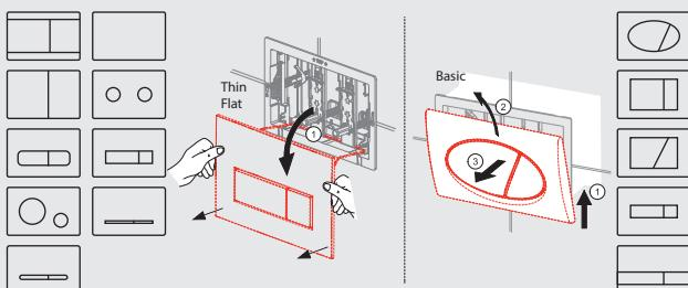
**3. Entfernen Sie die innere Platte, die die Platte vom WC-Modul trennt.** Sie können die Platine entfernen, indem Sie die Griffe an der Oberkante der Platine lösen.
