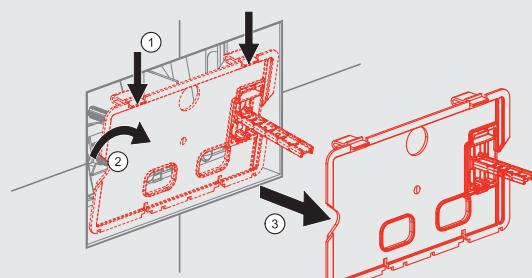
**5. Entfernen Sie den Spülmechanismus, die die Spülventilstange steuert.**
