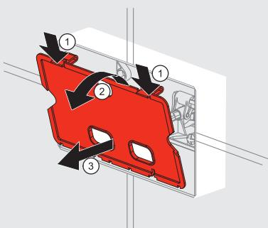
2. Távolítsa el a komplett nyomólapot a tartályról. Először oldja ki a rögzítőket, amik a nyomólap keretet a helyén tartják. Ezután használja az oldalsó bilincseket a nyomólap kioldásához és távolítsa el azt.
