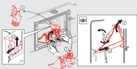
7. Csatlakoztassa le majd távolítsa el a töltőszelépet. Ez egyszerűbbé teszi az öblítőszelép kezelését.
