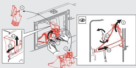
7. Szerelje össze az összes alkatrészt. Kezdve at öblítőszelep rúdjával (menjen biztosra, hogy csatlakoztatva van az öblítő mechanikához), aztán szerelje vissza a belső takarólapot („klikk” hangot kell halljon) és szerelje vissza a nyomólapot.
