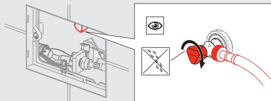
8. Távolítsa el az öblítőszelépet és ürítse ki a vizet a tartályból. Az öblítőszelép eltávolításához egyszerűen húzza felfelé azt.
