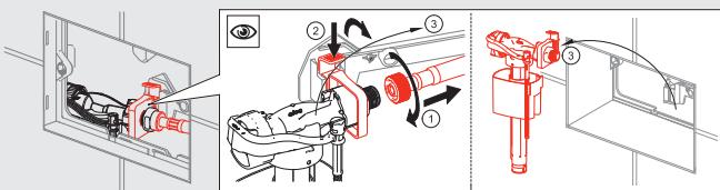
4. Amennyiben falsík alatti szerelési rendszere WC tabletta adagolóval felszerelt, távolítsa el.
