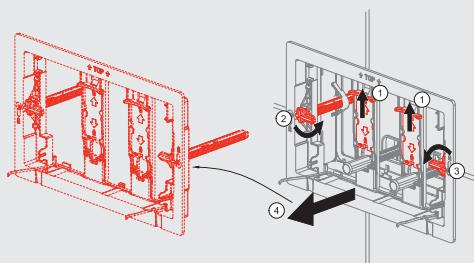
4. Amennyiben falsík alatti szerelési rendszere WC tabletta adagolóval felszerelt, távolítsa el.
