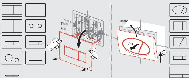
2. Távolítsa el a komplett nyomólapot a tartályról. Először oldja ki a rögzítőket, amik a nyomólap keretet a helyén tartják. Ezután használja az oldalsó bilincseket a nyomólap kioldásához és távolítsa el azt.
